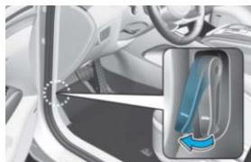
Tire de la palanca de liberación. El capó debería abrirse ligeramente.
