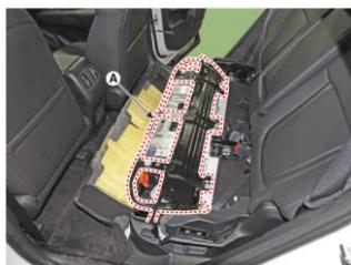
Encontrará conducto de entrada/salida y sistema de batería HEV.
