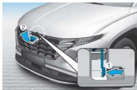
Levante ligeramente el capó, empuje el pestillo secundario hacia arriba (①) en el centro del capó y levante el capó (②)
