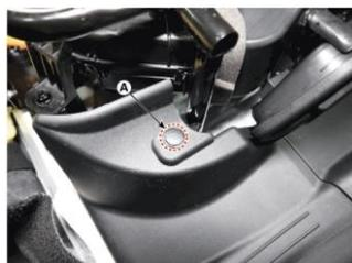
Desmonte el sujetador del guarnecido de la puerta trasera (A).
